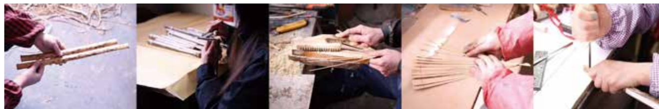
组图： 折扇制作的部分流程：折扇选料配料、测量折扇排口、扇骨造型、打磨扇骨、折扇装订
