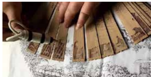
组图： 檀香扇制作的部分流程：拉花、烫花
