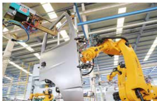
五征集团生产车间内的自动焊装生产线
